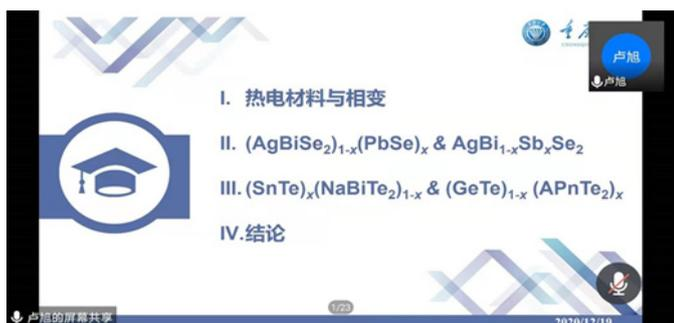
随后, 重庆大学物理学院卢旭研究员解释了相变与热电材料及其性能间的关系, 并以 n 型 AgBiSe<sub>2</sub> 为例阐述相变与运输性质之间的关联。卢旭研究员谈到, AgBiSe<sub>2</sub> 是化合物中不多见的 n 型半导体, 具有低晶格热导率和较好的热电优值, 然而 AgBiSe<sub>2</sub> 晶体结构并不稳定, 经过两次结构相变后在高温进入立方相。接下来, 卢旭研究员分享了课题组的研究成果: 利用固溶带来的结构熵增加在整个温区实现立方相的稳定, 并且研究熵增和固溶体迁移率之间的定量关系, 最终筛选出最佳组分, 实现了兼具高热电性能和稳定立方结构的 AgBiSe<sub>2</sub> 材料。
