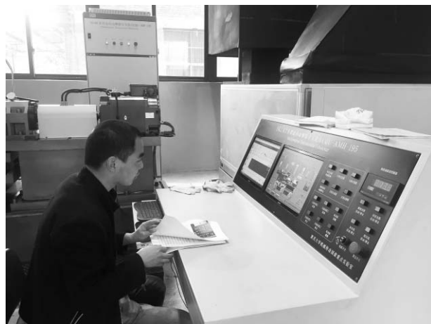
多用途传动摩擦学试验台
