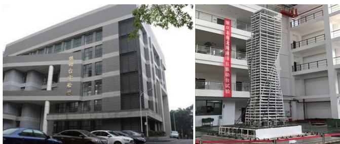
此次振动台试验对象为高科太阳座超高层建筑，位于重庆北部新区两江幸福广场北侧，拟建成重庆市标志性建筑。该建筑共42层，高214米，总面积约10万平方，屋顶设有直升机停机坪，采用空间扭曲斜柱和屋面收进以增加建筑美观，为典型的不规则结构，不利于抗震。本次采用缩尺模型试验，模型为原型的1/25，模型高度9.25米，模型重量43吨，输入7组地震，调整地震强度分别进行了6度小震、
