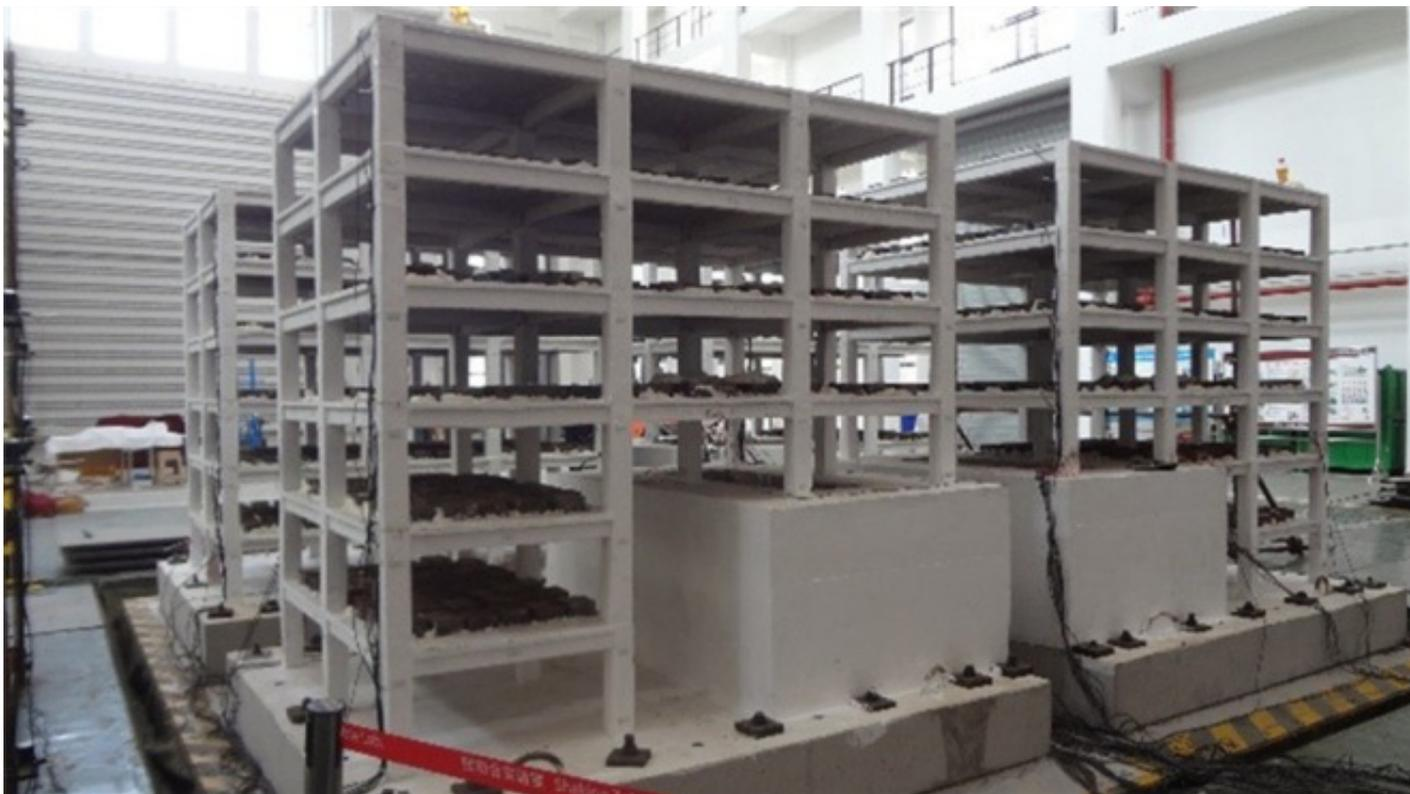
2018年4月7日至4月8日，重庆大学振动台实验室顺利完成了山地建筑结构地震响应特征及破坏机理振动台试验。这次试验为国际上首次专门针对山地建筑结构的大型振动台试验，对于该类结构的抗震性能的研究具有重要意义，将为山地建筑设计规范的编制和山地工程的实施提供可靠数据。
